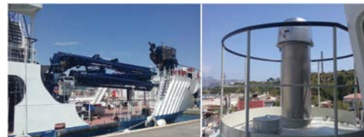
Slika 7. Lijevo: raspodjelna grana; desno: odušnik / filter spremnika za cement.
