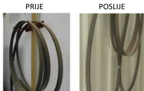
Slika 8: Tako jednostavno rješenje -Zubi tračne pile okrenuti prema stražnjem dijelu nosača
